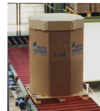
Box-filling (octabin) for PE-granules
