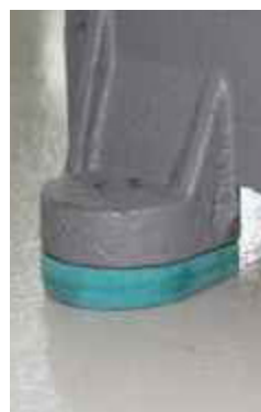
Lager under maskinfäste.
