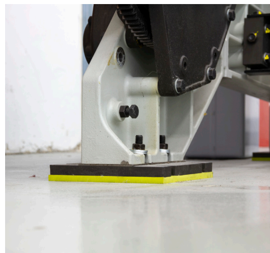
Isolering av industrimaskin med hjälp av Sylodamp.
