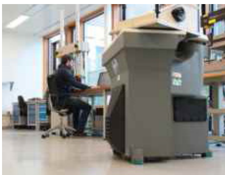
Vibrationsisolering av en formskärare för kontinuerlig drift.
