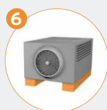
Vibrationsdämpning av installationer
