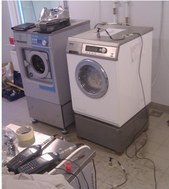
Figur 2. Maskinuppställning på fundament i tvättstuga
