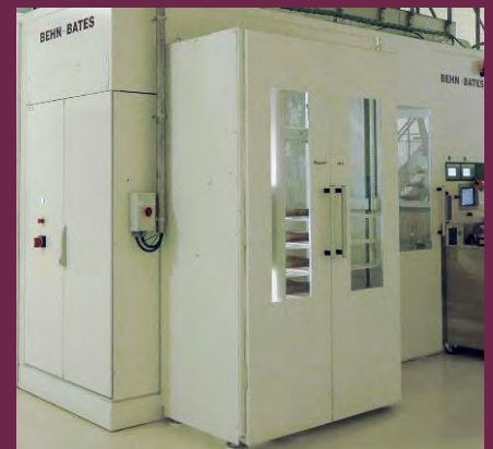
Vertikalmagazin, integriert im Maschinengehäuse, für mehr Sauberkeit und bessere Raumnutzung
