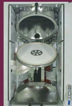
Kesselboden: Geschlossen und offen, mit Produktaufschale für einfache und schnelle Reinigung
