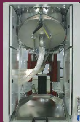
Kesselboden: Geschlossen und offen, mit Produktaufschale für einfache und schnelle Reinigung
