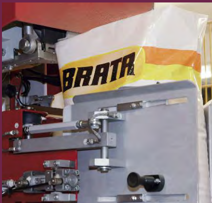
Ventilsack-Verschließung mittels Ultraschall direkt am Füllstutzen
