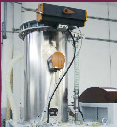
Füllkessel in Edelstahlausführung, elektrolytisch poliert
