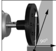
Pour mesurer avec contact à l'aide d'une touche de mesure (cône de mesure), positionner l'appareil droit au centre de l'objet en rotation.
