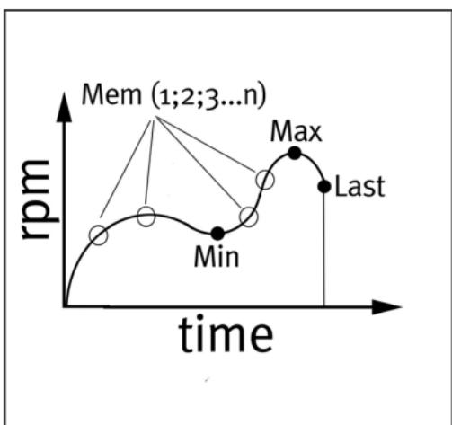
Messwert. Zusätzliche Messwerte können gespeichert werden, wenn während der Messung die MEM Taste gedrückt wird, einige Modelle errechnen hieraus auch den Durchschnitt als Mittelwert (AV).
