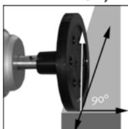
En caso de medición de velocidad y longitudes con aparatos de rueda de medición, sujetar el aparato recto y perpendicular al sentido de marcha del objeto.
