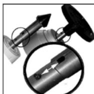
Pousser les touches de mesure et les roues mesurées sur la tige de mesure – Faire attention à la goupille de serrage et à la rainure!
