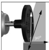
Bei Geschwindigkeits- und Längenmessung mit Messrad, Gerät gerade und im rechten Winkel zur Laufrichtung des Objektes halten.
