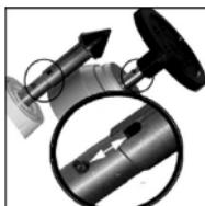
Deslizar las puntas y ruedas de medición sobre el árbol de medición – ¡Observar el pasador de sujeción y la ranura!
