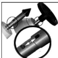
Porre le punte di misurazione e le rotelle di misurazione sull'albero di misurazione – tenere conto dello spinotto tenditore e della scanalatura!
