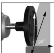
In caso di misurazione di velocità e lunghezza con rotella di misurazione, tenere l'apparecchio diritto e ad angolo retto rispetto alla direzione di moto dell'oggetto.
